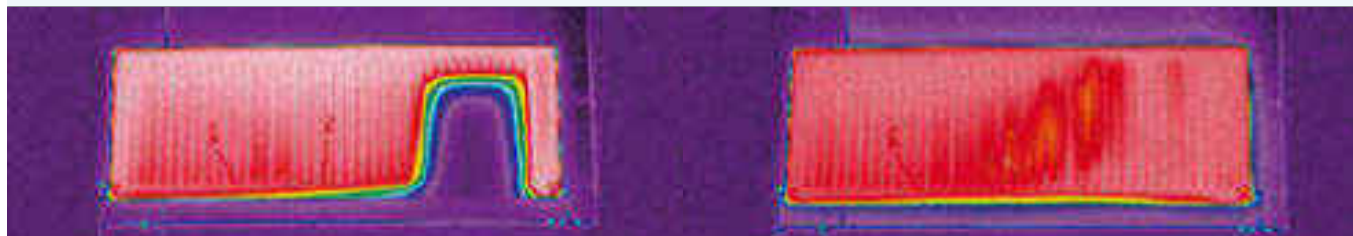
PRIMA: Zona fredda per presenza di fanghi
